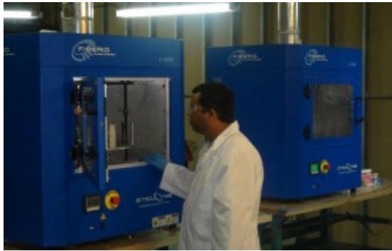
Obr.7.40.A: Zařízení OZ pro středně kapacitní výrobu. B: Ukládání vláken do vřetena.
